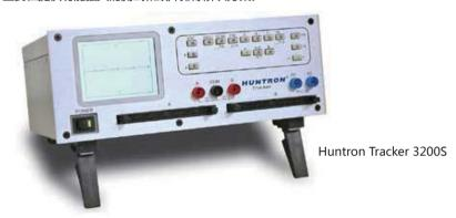
Tracker 3200S 配备多范围可选择的设置参数,包括电压,电源电阻和频率,可以多达 100种的组合测试条件。你可以设定创建追踪器的测试范围使能够精确的满足您的需求。 Tracker 3200S 使用彩色,触控液晶屏幕,可以方便控制设定,例如范围设置,内置的脉冲 产生器, 前面板引脚选择和通道A/B 的设定。Huntron Tracker 3200S液晶显示器提供了 ·个非常快速的屏幕刷新率接近于静电CRT显示器的速度的组件引脚快速筛选和显示A和 B信道信号波形的同时(A+B模式)。它配备了两个64针IDC连接器用于与IC夹或客户自 建接线或连接到Huntron Access 探针测试台全自动化诊断。
