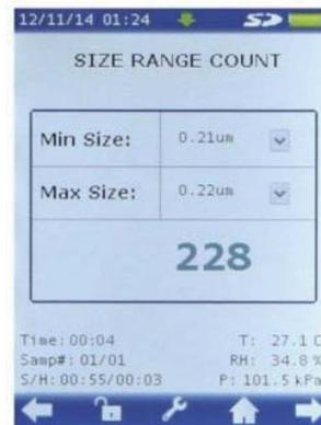
高级功能可设定特殊颗粒尺寸的范围进行精确测量，解析度高达10μm
