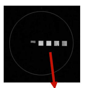
Bad film thickness, particle, litho trouble can be detected レジスト塗布時のスピンコートムラ、パーティクルの付着、レジスト現像残り等が確認できる。
