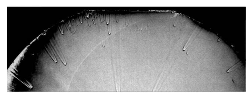
Comet(bad film thickness) by Particle スピンコート時にレジスト塗布を行なうウェーハ表面に付着したパーティクルが核になり、そこから放射状にレジストが尾を引いた膜厚ムラを発生させた例。
