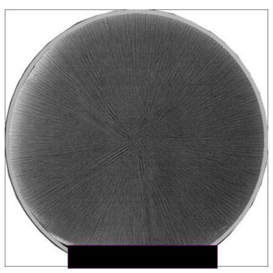
Bad film uniformity after resist coating. This sample has radiate film ununiformity. スピンコータでレジスト塗布を行い、ベークしたウェーハの表面。ウェーハ中心から放射状にレジストの膜厚むらとなるスジが伸びていることが観察さできる。
